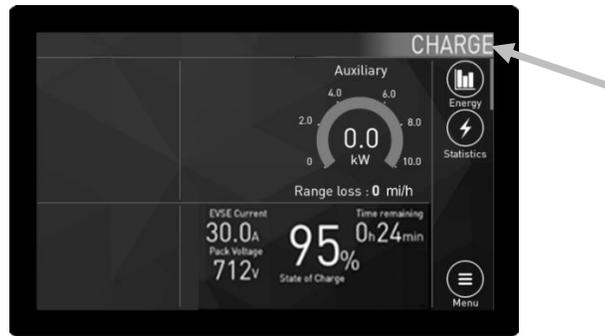
**Auxiliary Power** (energía auxiliar): el medidor de energía auxiliar monitorea el uso de los otros componentes del chasis.
