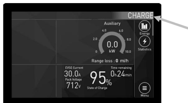
**Puissance auxiliaire** : la jauge de puissance auxiliaire surveille l'utilisation des autres composants du châssis.
