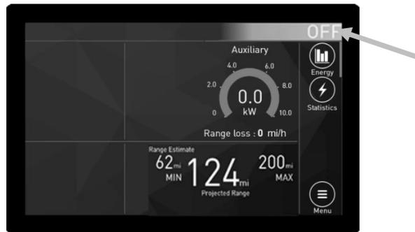
**CONDUITE** : le bus haute tension est activé et le camion est entièrement opérationnel.
