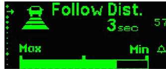
Nivel 2 Alerta de distancia en relación al vehículo que está adelante suyo
