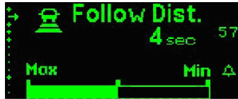
Nivel 3 Alerta de distancia en relación al vehículo que está adelante suyo
