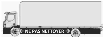
Évitez de mouiller l'ensemble du châssis, en particulier les endroits où les systèmes et les câbles des batteries sont placés.
