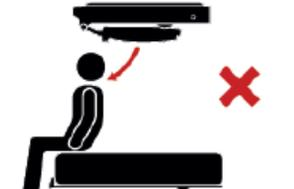
N'essayez pas d'ouvrir l'échelle pendant qu'un occupant se trouve en position assise dans la couchette inférieure. L'occupant pourrait être blessé. L'échelle risquerait d'être endommagée.
