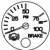
Cet indicateur signale la pression d'air appliquée à l'aide de la pédale de frein du véhicule ou de la commande manuelle de frein de la semi-remorque.
