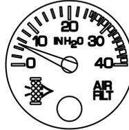
Cet indicateur signale l'état du filtre à air du moteur, mesuré en pouces d'eau (H<sub>2</sub>O). Un filtre propre devrait indiquer 7 po H<sub>2</sub>O (ce qui peut varier avec les systèmes) alors qu'un filtre en fin de vie utile indique 20 po H<sub>2</sub>O. Le témoin rouge s'allume lorsque la température atteint un niveau critique. Ce niveau est déterminé par le moteur et les sélections du filtre à air.
