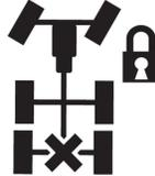
Le différentiel inter-essieux permet à chaque essieu de tourner indépendamment, ce qui élimine les contraintes sur les essieux arrière et réduit l'usure des pneus. Une commande placée sur le panneau des accessoires permet de verrouiller le différentiel inter-essieux, ce qui donne une meilleure traction sur les surfaces glissantes. Notez que ce commutateur fait l'objet d'une protection afin d'éviter son actionnement accidentel.
