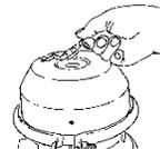
1. Déposez le bouchon du récepteur des freins à ressort.
