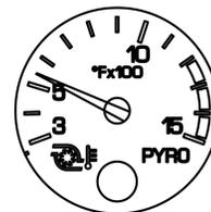
Cet indicateur donne la température des gaz d'échappement. Étant donné que cette sonde répond immédiatement aux changements de température, le pyromètre est un excellent moyen de déterminer le rendement du moteur. Surveillez cet instrument conjointement avec le compte-tours et avec le manomètre de la tubulure d'admission. Le pyromètre peut vous aider à conduire votre véhicule de façon efficace et à éviter les changements brusques dans la température de marche du moteur.
