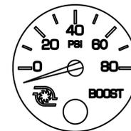
Ce manomètre donne la puissance fournie par votre moteur en indiquant la pression de suralimentation. Si la pression indiquée par ce manomètre diminue, cela peut être le signe d'un problème de moteur. Faites-le vérifier par un mécanicien qualifié.
