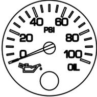
Il est important de maintenir la pression d'huile dans des limites acceptables. Si la pression d'huile chute en dessous de la pression minimum en psi, un témoin rouge s'allume sur l'indicateur, le témoin Stop Engine (coupure du moteur) s'allume et une alarme retentit.
