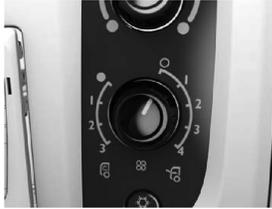
Le ventilateur comporte deux vitesses : l'une sert aux fins de recirculation et l'autre aux fins d'apport en air frais. La position de recirculation convient pour le désembuage rapide ou pour refroidir la cabine avec la climatisation, pour chauffer rapidement la cabine, dégivrer les vitres avec le chauffage et éliminer les odeurs désagréables.
