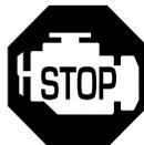
Luz Stop engine (Detener el motor); color rojo.
