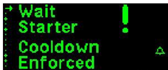
Protección de sobre arranque
