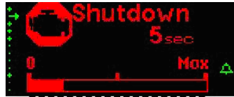
Temporizador apagado para protección del motor
