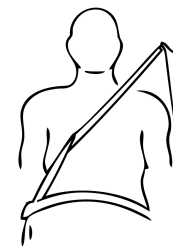
Mauvaise position (tordue)
