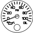
Es importante mantener la presión del aceite dentro de los límites aceptables. Si la presión del aceite está por debajo de psi mínima se encenderá una luz de advertencia roja en el indicador, se encenderá la luz de detener el motor y sonará la alarma.
