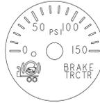
El indicador de presión de aire de la aplicación del freno del tractor indica la cantidad de presión de aire aplicada a los frenos del tractor.
