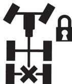
El diferencial entre ejes permite que cada eje gire independientemente, lo que libera la tensión de los ejes traseros y disminuye el desgaste de las ruedas. Un interruptor que está en el panel de interruptores auxiliares bloquea los diferenciales entre ejes, lo que le proporciona mejor tracción en superficies resbalosas. Usted notará que el interruptor tiene un protector para evitar que se active accidentalmente.
