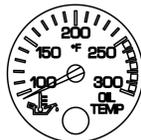
El indicador de temperatura del aceite del motor muestra la temperatura del aceite del motor. Si la temperatura del aceite supera el límite máximo, se encenderá una luz de advertencia roja en el indicador. No sobrepase la temperatura máxima del aceite del motor que recomienda el fabricante del motor. (Consulte el *Manual de funcionamiento y mantenimiento del motor* para obtener más detalles).
