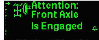
Advertencia de velocidad del eje de transmisión delantero
