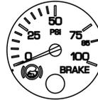
El indicador de aire de aplicación del freno le indicará cuánta presión de aire se está aplicando desde la válvula del freno de pie o de la válvula manual del freno de remolque a los frenos de aire.
