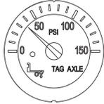
El indicador de presión de aire del eje trasero indica la cantidad de presión de aire en las bolsas de aire de la suspensión del eje trasero.
