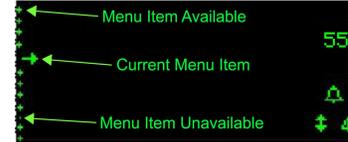
La barra de menú del lado izquierdo (viñetas de menú) da el estado del elemento de menú actual. Desplácese por los elementos del menú al girar el interruptor de control del menú (MCS) hacia la derecha (hacia abajo del menú) o hacia la izquierda (hacia arriba del menú) Seleccione un elemento del menú, al presionar el MCS Algunos elementos del menú requieren que se presione el MCS para obtener acceso a la información del submenú.
