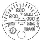
El indicador de temperatura del aceite del retardador de la transmisión indica la temperatura del aceite en el retardador de la transmisión.
