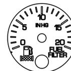
Este indicador le indica la condición en la que se encuentra el filtro de combustible, al indicar la restricción del filtro de combustible a la bomba de combustible. La restricción se mide en pulgadas de mercurio (Hg). Revise el manual del motor para la restricción adecuada. Reemplace el filtro únicamente por un filtro aprobado. No sustituya el elemento micrón equivocado.
