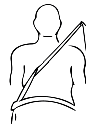
Mauvaise position (tordue)
